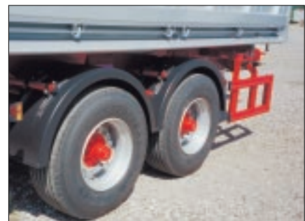
Kunststoff-Halbschalen-Kotflügel und seitlichen Anfahrtschutz (Exportausführung)
